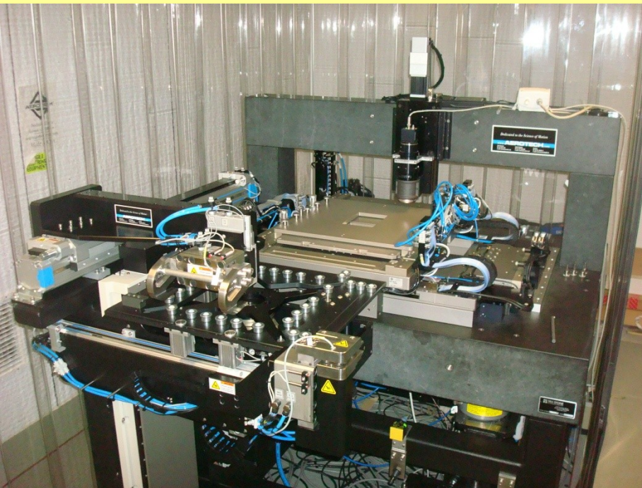
Machine à scanner les plaques de l'observatoire royal de Belgique (précision 70 nanomètres)
