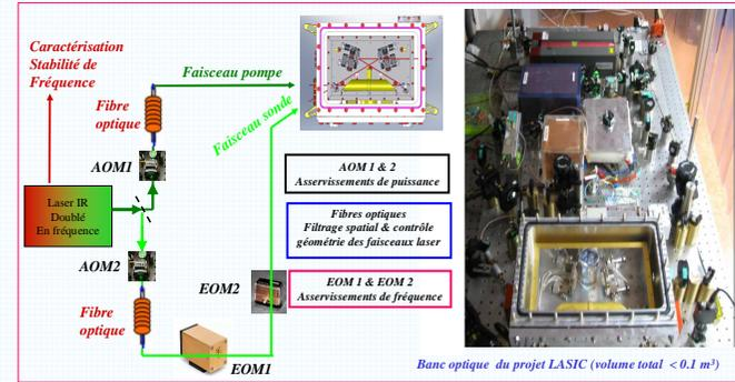
**Évaluation préliminaire de la stabilité de « LASIC » utilisant une cavité optique de démonstration opérant à l'air libre**
